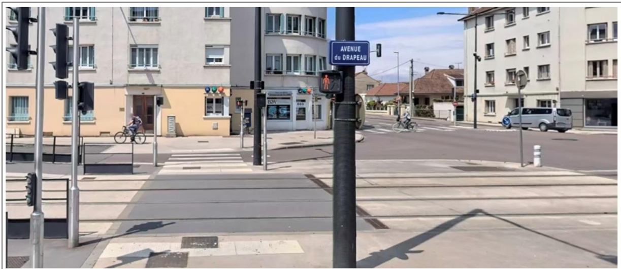
Figure 3 : exemple de traversée multiple de type R12-R25-R12
