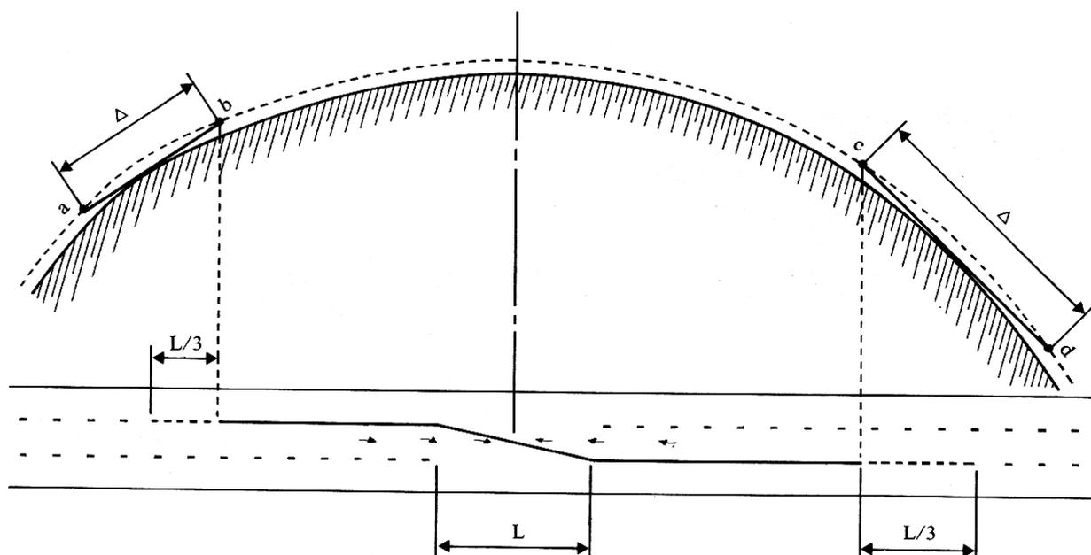
Lorsque la zone sans visibilité est de faible longueur, deux voies sont affectées, sur le point singulier considéré, préférentiellement à un sens de circulation. Qu'il y ait ou non recouvrement des zones de visibilité au sommet du dos-d'âne, le rabattement doit être effectué au point  $a$  ou au point  $d$  suivant le sens préférentiel qui a été retenu.
