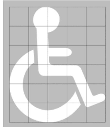
Le pictogramme conforme au modèle figurant ci-dessous est peint en blanc sur les limites d'un emplacement de stationnement, pour rappeler qu'il est réservé au stationnement des véhicules électriques pendant la durée de recharge de leurs accumulateurs. Les dimensions du pictogramme sont de 0,6 m x 0,3 m ou de 0,3 m x 0,15 m.
