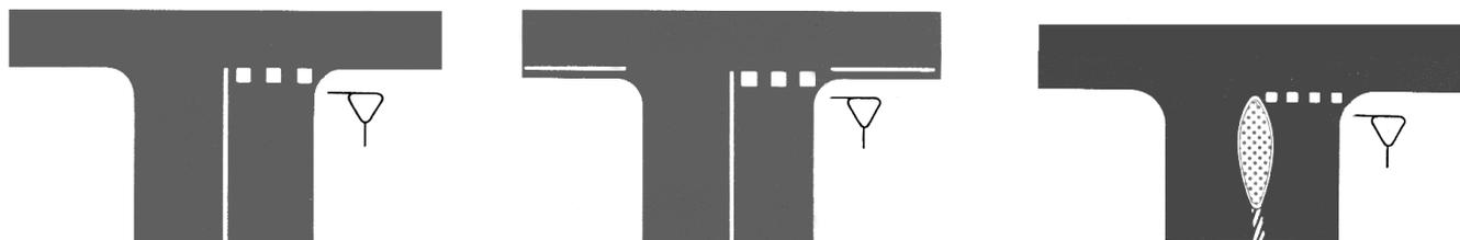
Avant la ligne transversale de type T'2, il peut être dessiné sur la chaussée, un triangle dont un côté est parallèle à la ligne et dont la pointe est dirigée vers les véhicules qui approchent (voir schéma D7 en annexe).
