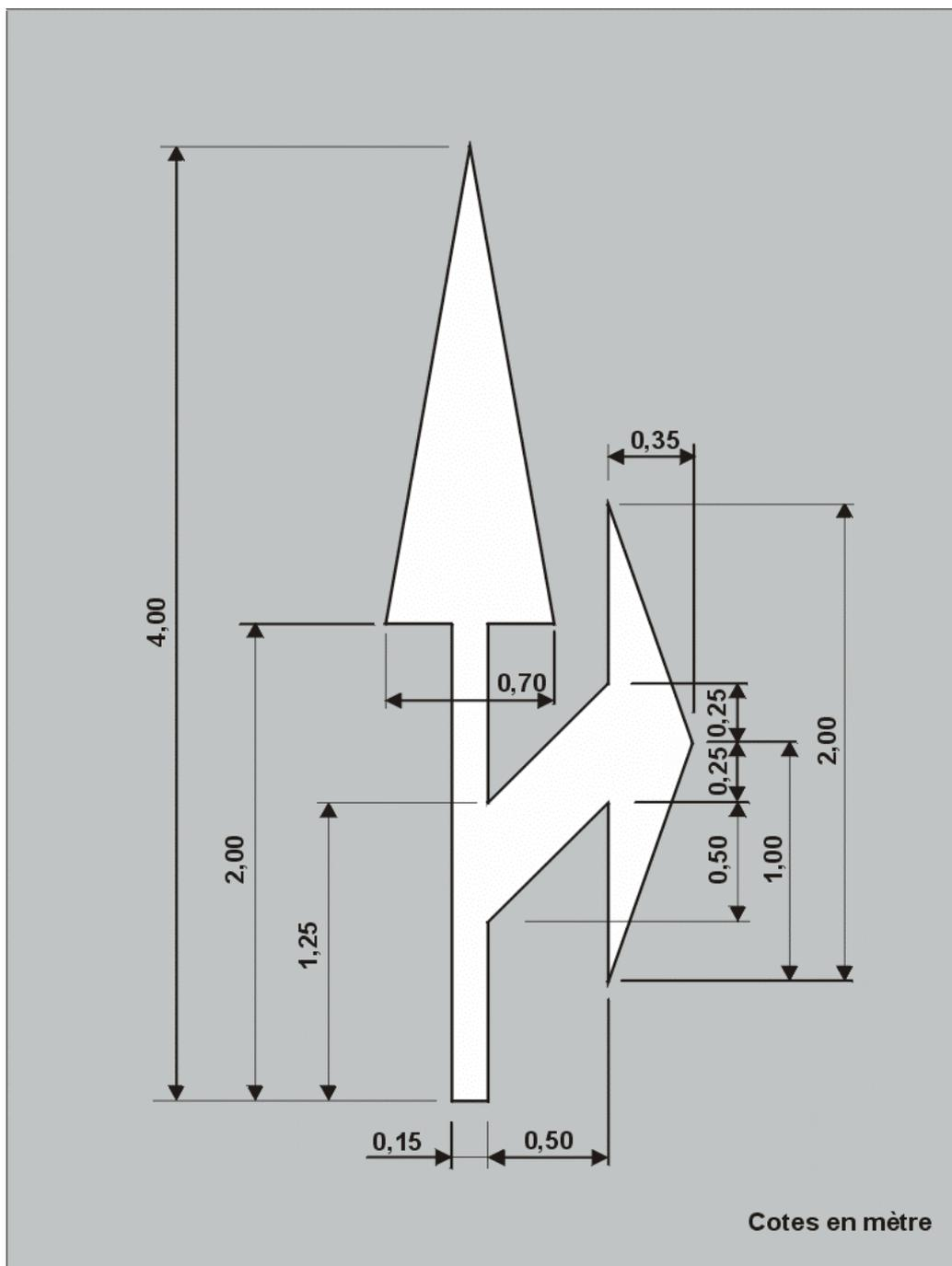
*Nota* : sur autoroutes et routes à chaussées séparées à carrefours dénivelés, les flèches utilisées ont des dimensions qui se déduisent des dimensions ci-dessus par une homothétie de rapport 4/3.
