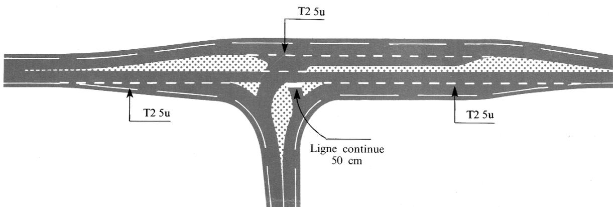
De même pour une bretelle d'entrée ou une convergence d'autoroutes, si la chaussée aval a le même nombre de voies que la chaussée amont, on trace en prolongement du nez géométrique, une ligne de type T2 et de largeur 5u qui se poursuit jusqu'à la ligne de rive.
