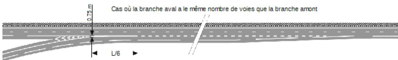
Si la chaussée aval a un nombre de voies supérieur, on trace une ligne de type T2 de largeur 5u en prolongement du nez géométrique sur une longueur de L au minimum depuis le point où le biseau a une largeur de 1,50 mètre.
