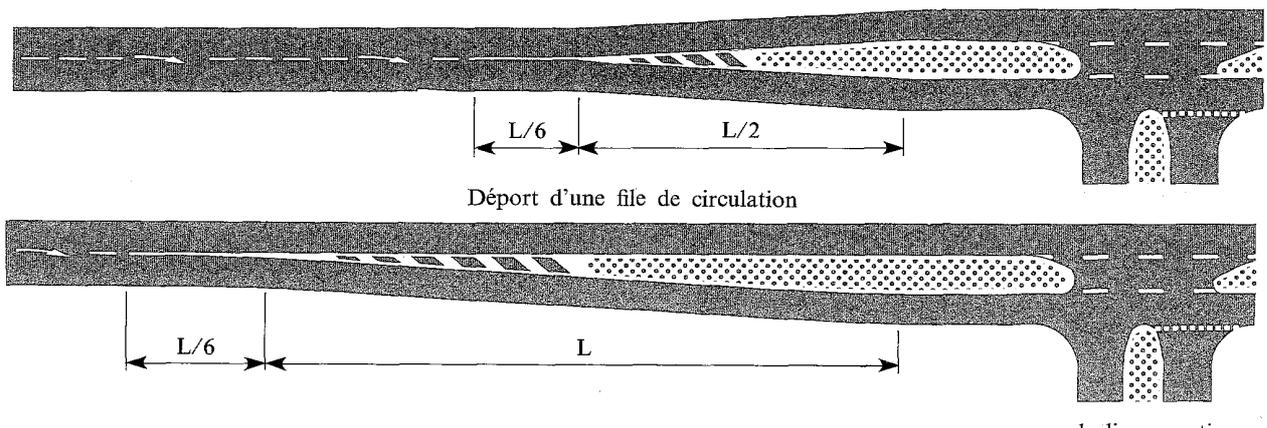
Par contre, lorsque l'implantation des têtes d'îlots est dissymétrique et correspond à un déport effectif d'une file de circulation, la longueur de la ligne oblique est égale à  $L$ .
