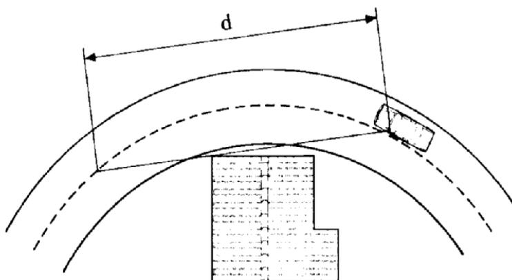
Les règles prévues à l'article R. 412-18 et R. 412-20 du code de la route conduisent à établir, au moyen d'une combinaison de lignes continues et discontinues, des zones de dépassement interdites aux points singuliers où la distance de visibilité est inférieure à un certain minimum  $\Delta$ .
