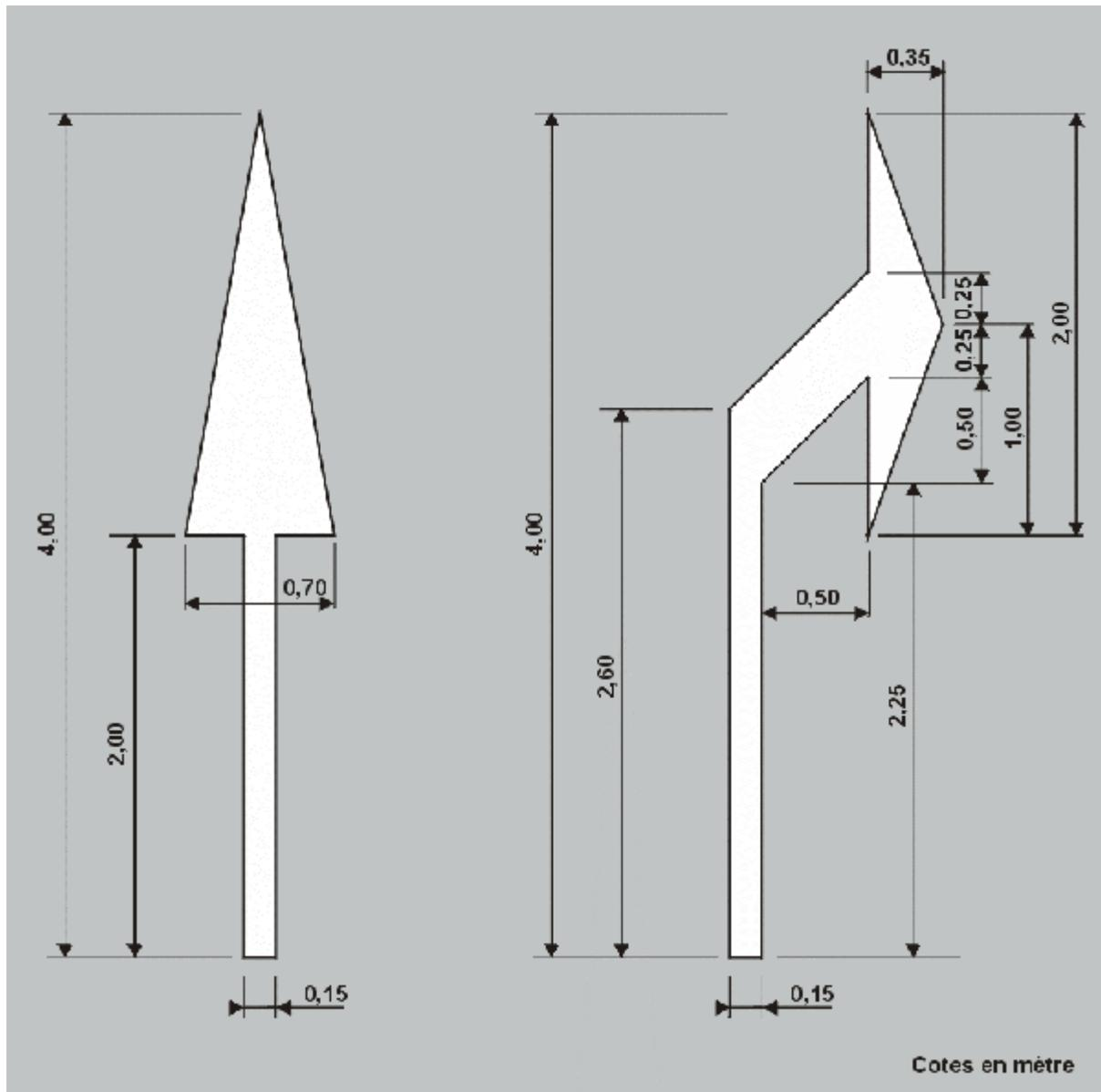
*Nota* : sur autoroutes et routes à chaussées séparées à carrefours dénivelés, les flèches utilisées ont des dimensions qui se déduisent des dimensions ci-dessus par une homothétie de rapport 4/3.
