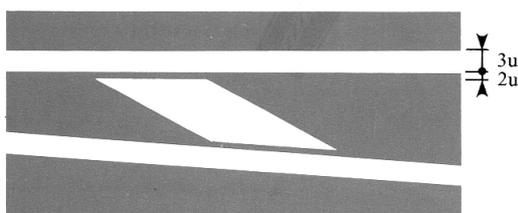
L'inclinaison des hachures est telle qu'elle tend à ramener l'utilisateur vers l'axe de la voie de circulation qu'il emprunte. Aux points de convergence ou de divergence, les hachures se présentent donc sous forme de chevrons convenablement orientés (pointe toujours dirigée vers le conducteur). L'inclinaison deux sur un des hachures est alors définie par rapport à la bissectrice de l'angle.
