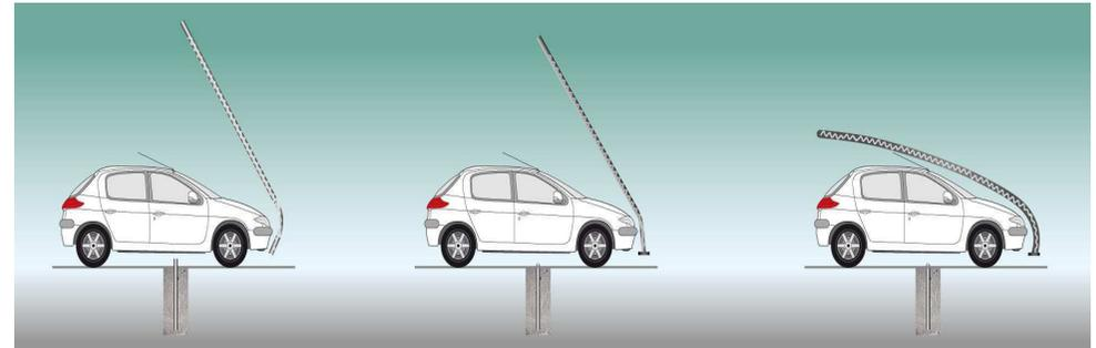
Mode NS : le support se déforme mais ne se détache pas
