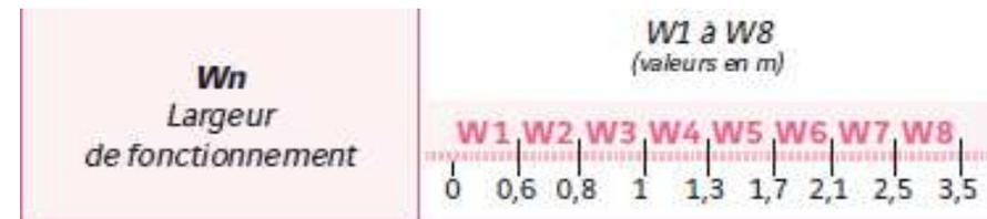
**$W_n$  : Largeur de fonctionnement normalisée mesurée en mètres (m)**
